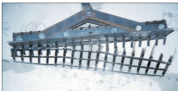
Рис. 5. Характер разрушения связей из базальтовой сетки (разрыв сетки) при вырыве из кладки
