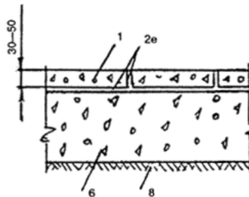
1 - покрытие из плит асфальтобетонных;
