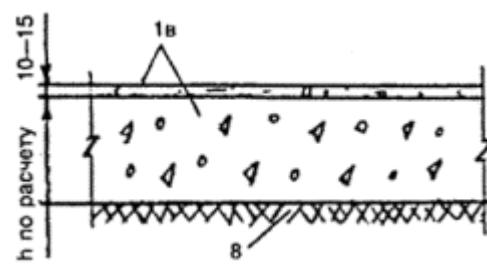
1а - верхний слой покрытия из мозаичного бетона (терраццо);
