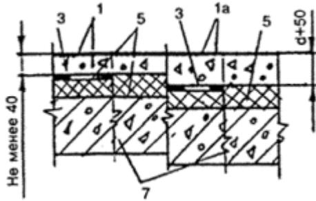
Плиты из жаростойкого бетона на портландцементе с хромитом и заполнителем из шлака по прослойке из песка
