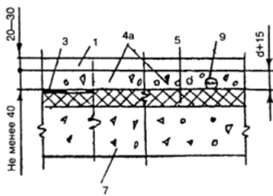
Кислотостойкий бетон на жидким стекле с уплотняющей добавкой:
