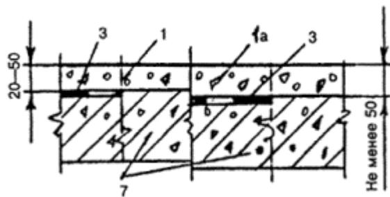
Цементно-бетонное в многослойной конструкции пола
