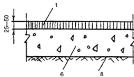
1 - покрытие из асфальтобетона;
